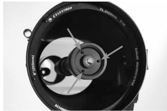
Tornillos de ajuste de colimado del espejo secundario
