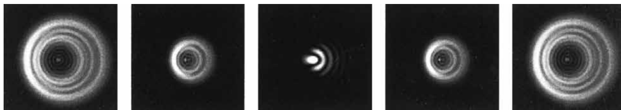
Collimazione dello specchio secondario regolando le viti
