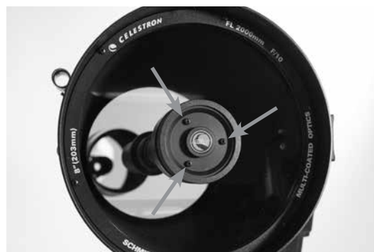
Collimazione dello specchio secondario regolando le viti
